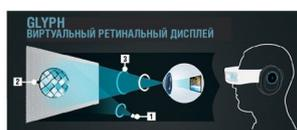
Виртуальный ретинальный монитор (Virtual retinal display, VRD; retinal scan display, RSD) — технология устройств вывода, проецирующая изображение непосредственно на сетчатку глаза. В результате пользователь видит изображение, «висящее» в воздухе перед ним.
