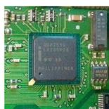
Сетевой процессор (англ. Network Processing Unit, NPU) - это программируемый микропроцессор, архитектура которого оптимизирована для использования в сетевых устройствах и обеспечения устойчивого режима обработки пакетов (packet processing). Сетевые процессоры, как правило, это интегральная схема с характеристиками, аналогичными центральным процессорам общего назначения.
