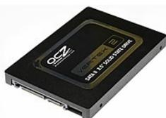
**Твердотельный накопитель** (англ. *solid-state drive, SSD*) — компьютерное энергонезависимое немеханическое запоминающее устройство на основе микросхем памяти, альтернатива HDD. Кроме микросхем памяти, SSD содержит управляющий контроллер. Наиболее распространённый вид твердотельных накопителей использует для хранения информации флеш-память типа NAND, однако существуют варианты, в которых накопитель создаётся на базе DRAM-памяти, снабжённой дополнительным источником питания — аккумулятором.
