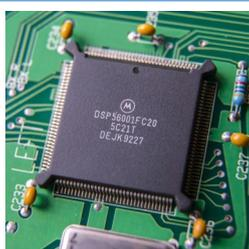
**Цифровой сигнальный процессор** (англ. *digital signal processor*, *DSP*, цифровой процессор обработки сигналов (ЦПОС)) — специализированный микропроцессор, предназначенный для обработки оцифрованных сигналов.
