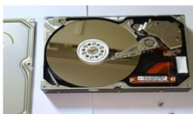
**Накопитель на жёстких магнитных дисках**, или **НЖМД** (англ. *hard (magnetic) disk drive, HDD, HMDD*), *жёсткий диск, винчестер* — запоминающее устройство (устройство хранения информации) произвольного доступа, основанное на принципе магнитной записи. Является основным накопителем данных в большинстве компьютеров.
